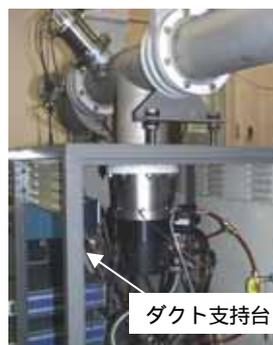
図9 イオン注入装置に設置されたターボ分子ポンプ
