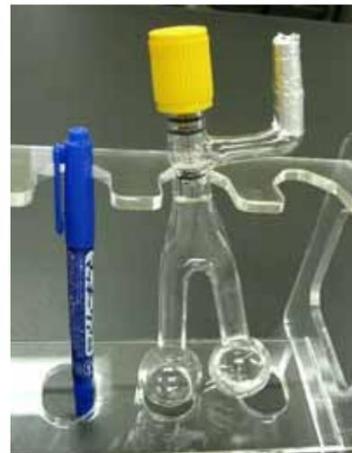
図 1：炭酸塩分解装置(左球形側に白点,C-1 10mg)
