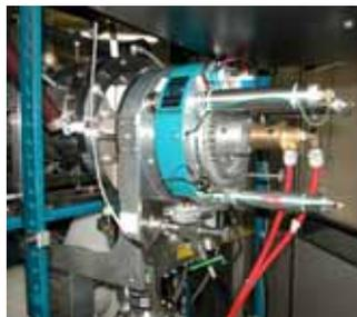
図 2 NEC 社製 MC-SNICS イオン源
