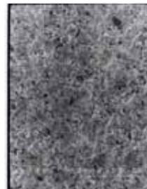
図 11 MALT 使用研磨剤使用後の Ta 板表面
