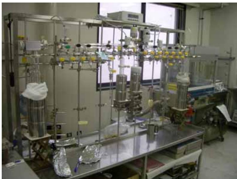
図2: CO<sub>2</sub>ガス精製用真空ライン
