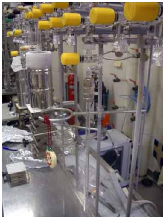
図3: 反応管部分の拡大図・触媒となる鉄粉が石英ガラス小管に約1mg入っている
