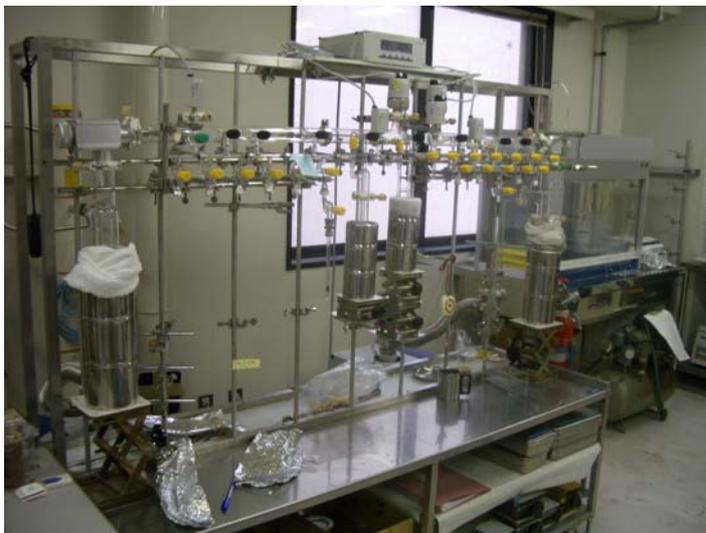
図 7 CO<sub>2</sub> ガス精製用真空ライン
