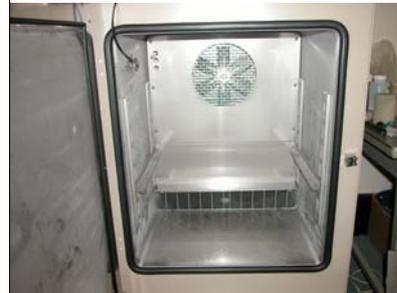
図3 恒温槽内部
