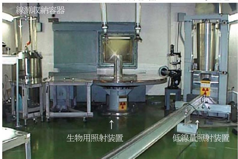
図1 生物用照射装置
