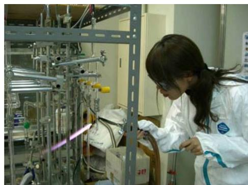
図6 ハンドバーナーでの封じ切り
