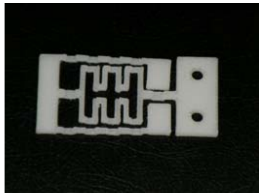
図 2. ABS 樹脂で製作した片持ち梁
