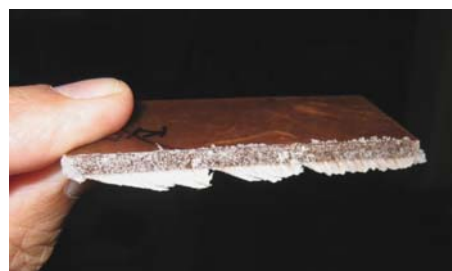
Fig.2 ケナフ／PLA 複合材の切断面 (硬いソバリの除去に苦労します)
