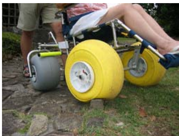
図3 屋外不整地用車椅子使用例
