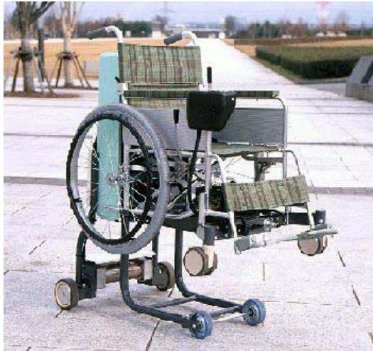
図4 段差乗り越え用車椅子例
