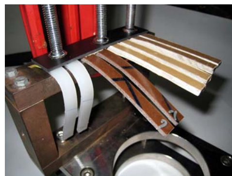
Fig.12 ヒートサグ法による耐熱性の試験結果
