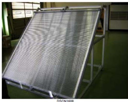
Fig10 チューブ型エア・リフト式 循環フォトバイオリアクター
