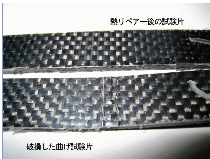
Fig. 1 破損した曲げ試験片 (下) と熱リペアー後の試験片 (上)
