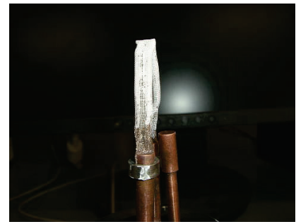
図6 酸化バリウムを塗布したフィラメント
