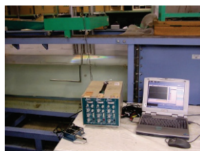
Fig.2 回流水槽観測部 Fig.3 球体周りの流れと剥離
