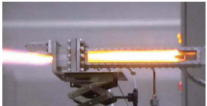
図7 希薄燃焼の保炎の様子
