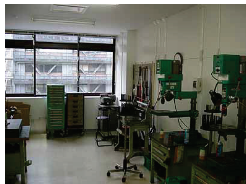
図 5 第 2 工作室(ボール盤・定盤室)
